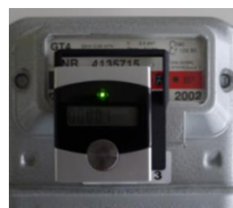
EnergyCam auf einem Gaszähler mit FAST Gas Meter Adapter Frame montiert
