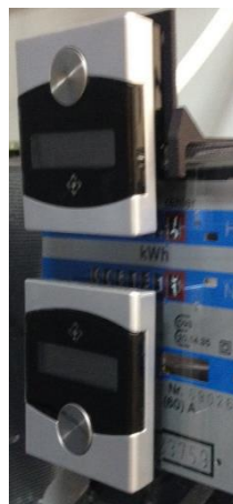
zwei EnergyCam Geräte auf einem HT/NT-Zähler
