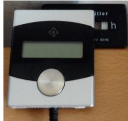
EnergyCam montiert auf einem Müller Betriebsstundenzähler
