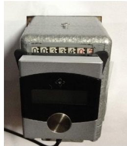
EnergyCam mit montiertem Gaszähler Adapter auf einem Braun HZ5 Ölzähler
